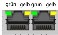
Steckverbinder-Bauart der ARGNET-Schnittstelle: RJ45-Buchse
