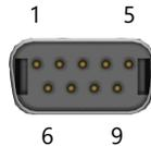
Steckverbinder-Bauart der PLC-AUX-Schnittstelle: (D-Sub) DE-9P
