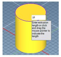
FIGURE 47- DEFINE THE EXTRUSION LENGTH
