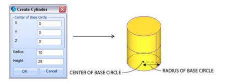
FIGURE 24- INSERT CYLINDER
