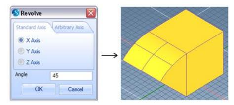
FIGURE 46- FACE REVOLVED BY A STANDARD AXIS
